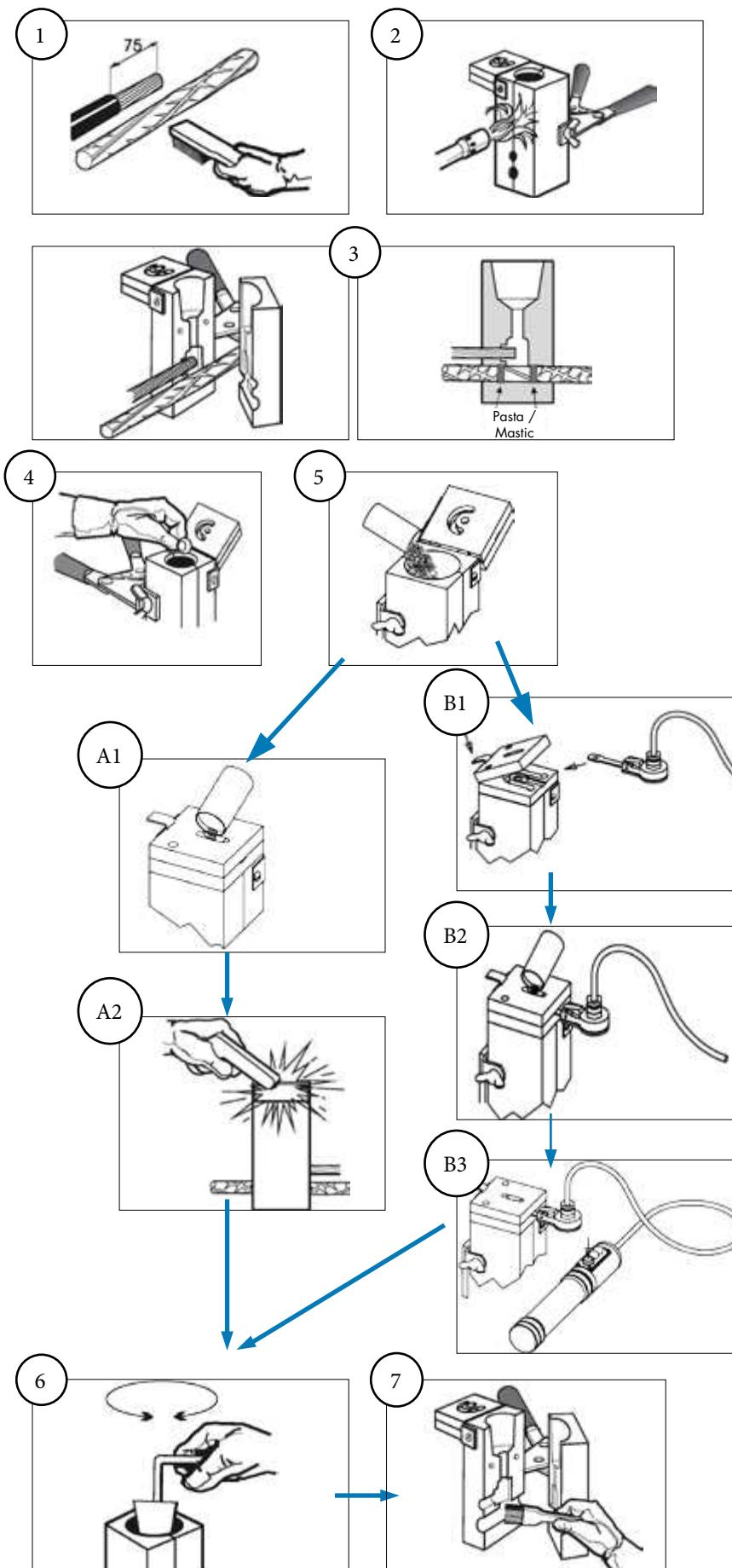
1 Empleando un cepillo metálico, limpiar los conductores a soldar // À l'aide d'une brosse métallique, nettoyer les conducteurs à souder // Using a metal brush, clean the conductors to be welded.
